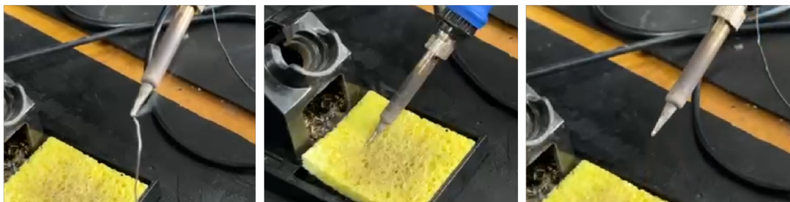
Figura 9.1.2: Processo de aplicar uma fina camada de estanho na ponta do ferro de solda.
