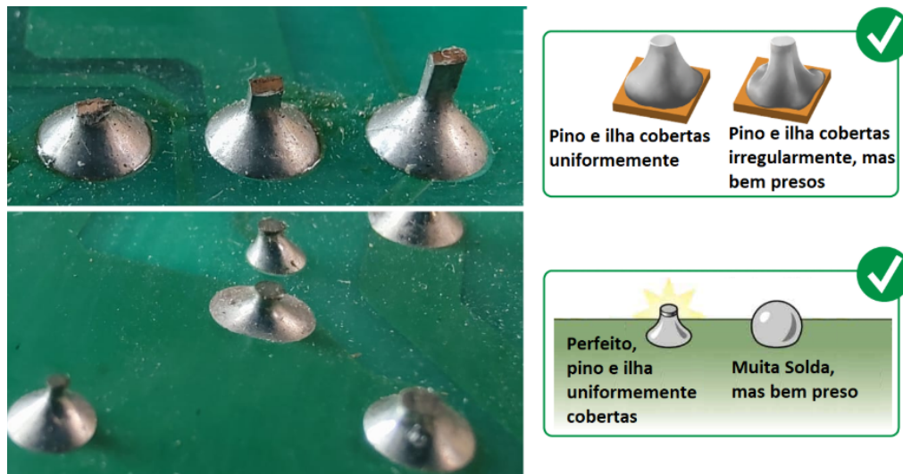
Figura 9.1.4: Exemplos de Boas Soldas.
