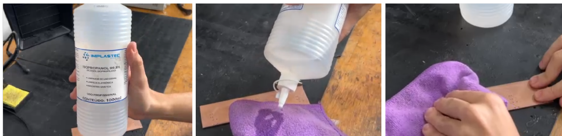
Figura 9.1.1: Forma correta de limpar uma placa de PCB
