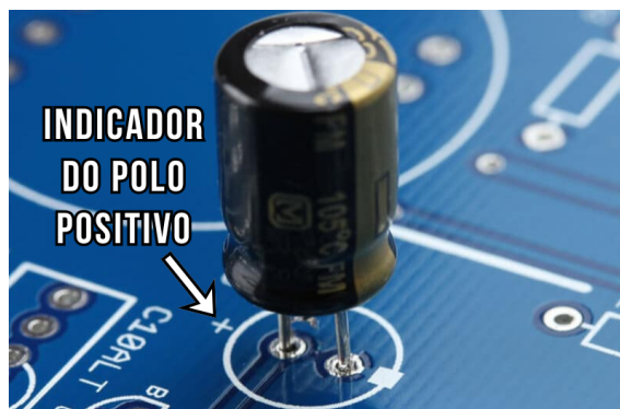
Figura 6.4.1: Indicador de Polaridade
